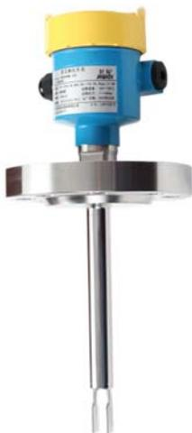
振动式物位开关是基于悬臂梁的振动原理，采用圆棒或音叉作为振动探头，利用压电器件实现振动的驱动与检测的一种物位测量仪表。计为振动式物位开关系列产品的各项性能指标达到行业先进水平，具有极高可靠性。当振动探头与被测介质接触时，振动探头的振幅或频率明显减小，压电检测器件输出信号幅度也随之减小，信号变化由智能电路检测分析并输出一个开关信号。根据被测介质的化学性质和物理结构的不同，可以选用不同系列的振动式物位开关。
