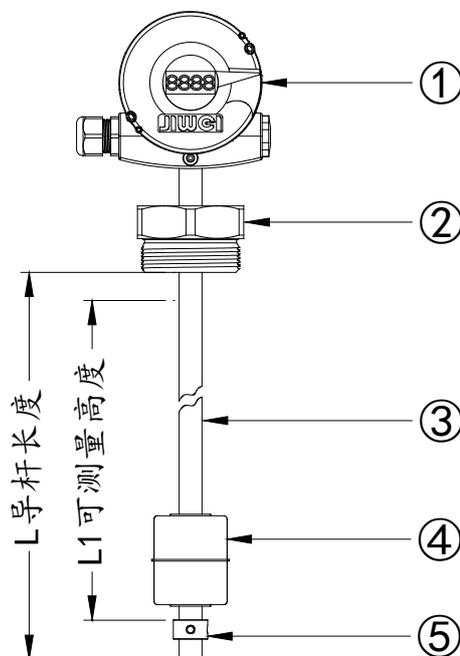
图 1 Float-11 整体结构图
